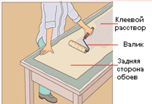
С помощью щетки нанесите клей на половину полосы, распределяя его от центра к краям. Хорошо нанесите клей по краям обоев.
